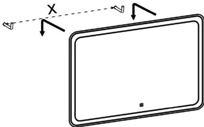
Обратите внимание, что зеркала должны быть установлены на минимальном расстоянии 150 мм до любой поверхности или предмета для обеспечения корректной работы датчика.
