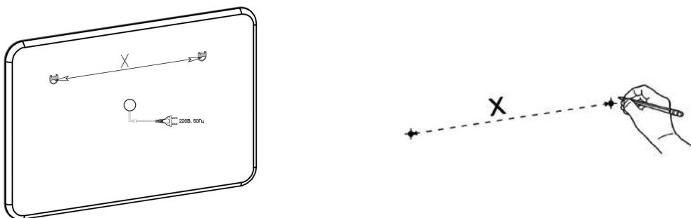
ШАГ 2. Нанесите разметку крепежных отверстий на стене (используйте пузырьковый или лазерный уровень)
